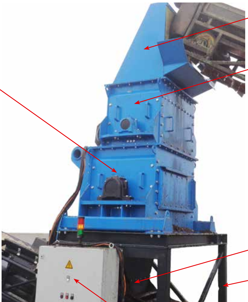
Schaltschrank mit Überwachungsampel
